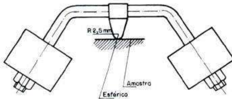
Figura B – Dispositivo de ensaio de pressão de esfera
