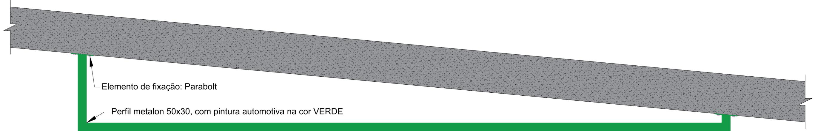
Elemento de fixação: Parabolt
