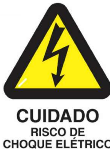
Figura 47 - Exemplo de advertência para quadros elétricos.
