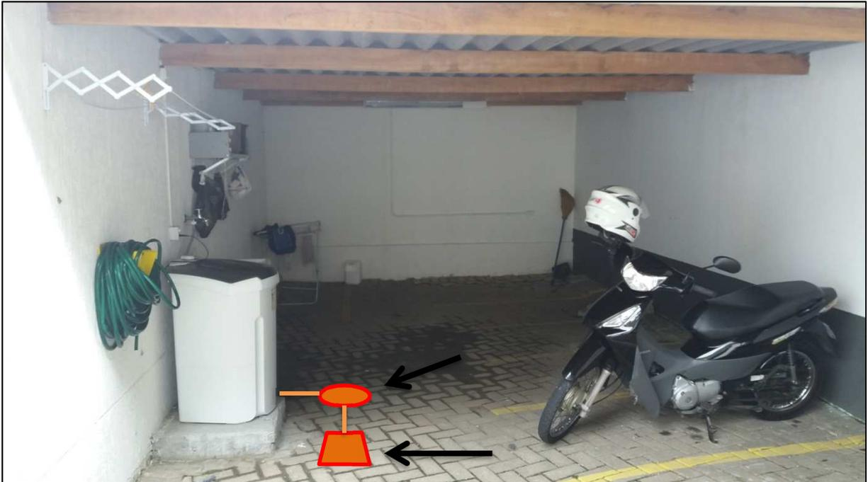
Figura 4 – Posições propostas para caixa de gordura e caixa de inspeção.
